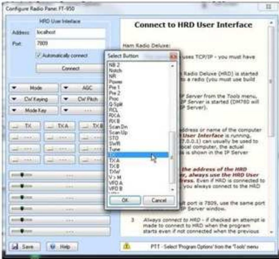
После открытия выберите и выделите "TX", как показано выше, и нажмите кнопку "OK" в нижней части меню выбора. Это настроит кнопку TX в панели радиостанции на использование соответствующих команд CAT для вашей радиостанции, чтобы активировать цифровую кнопку PTT при начале цифровой передачи.
